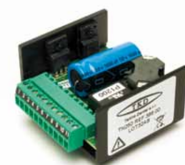
La scheda elettronica TN250 permette l'attivazione delicata delle vibrazioni e una potenza di uscita più stabile e costante al variare del carico.
